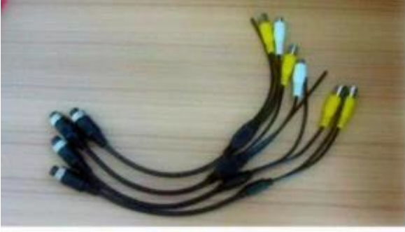
AV Input Cables
