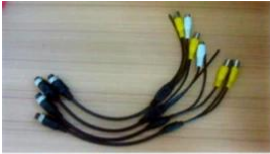
AV Input Cables
