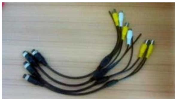
AV Input Cables
