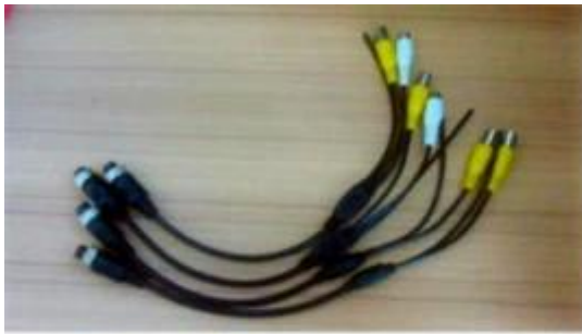
AV Input Cables
