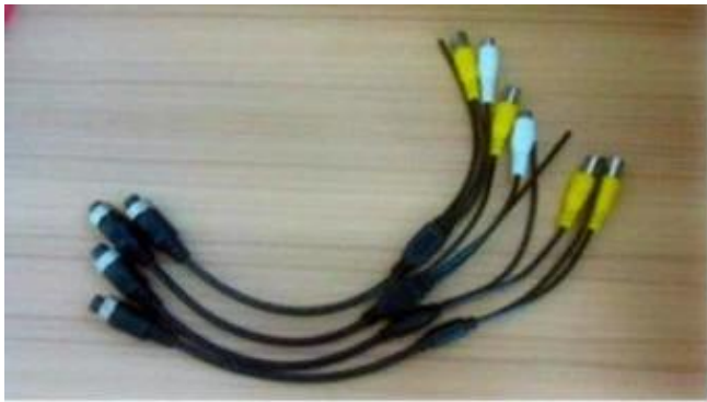
AV Input Cables
