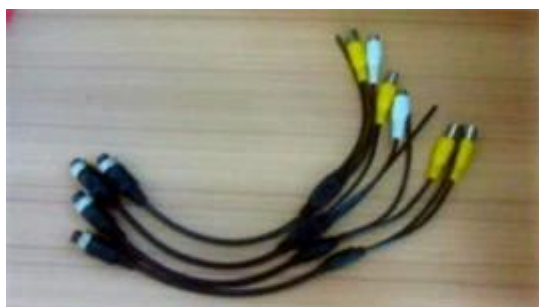
AV Input Cables
