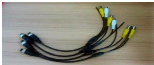
AV Input Cables
