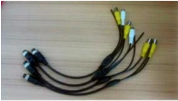
AV Input Cables
