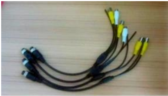
AV Input Cables
