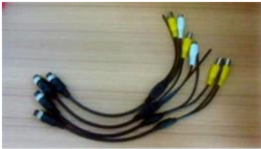
AV Input Cables
