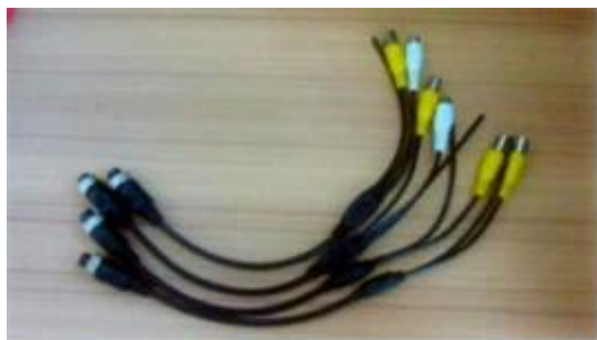
AV Input Cables
