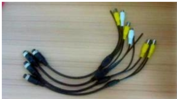
AV Input Cables
