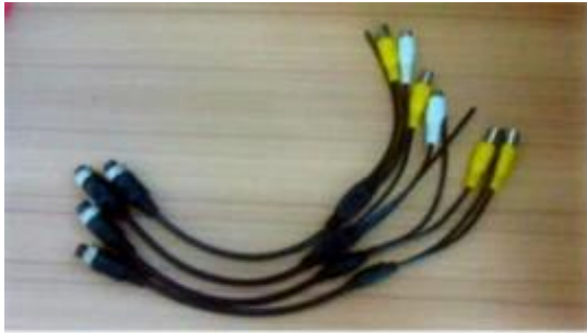
AV Input Cables
