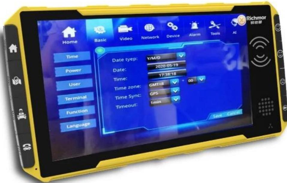
Richmor RCM-HA7 是一款功能强大的车载设备，支持 GPS / BD 定位、DMS 数据记录、TTS 语音播报、SMS 短信提醒、OBDR 故障诊断等多种功能。该设备采用先进的 GPS 芯片，定位精度高，支持北斗、GPS 双模定位。DMS 功能可实时记录车辆的行驶数据，为车队管理提供便利。TTS 功能可将行驶数据转换为语音播报，方便驾驶员了解车辆状态。SMS 功能可在车辆出现异常时发送短信提醒。OBDR 功能可记录车辆的故障信息，方便维修人员快速诊断。此外，该设备还支持多种扩展功能，如视频监控、报警提醒等。Richmor RCM-HA7 是您车队管理的理想选择。
