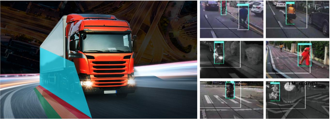
このシステムは、後方カメラ / 側方カメラ / 前方カメラを使用して、車両の周囲を監視し、盲点領域に車両が接近していることを検知します。検知された車両は、運転席のディスプレイに警告表示されます。
