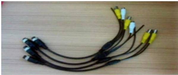
AV Input Cables
