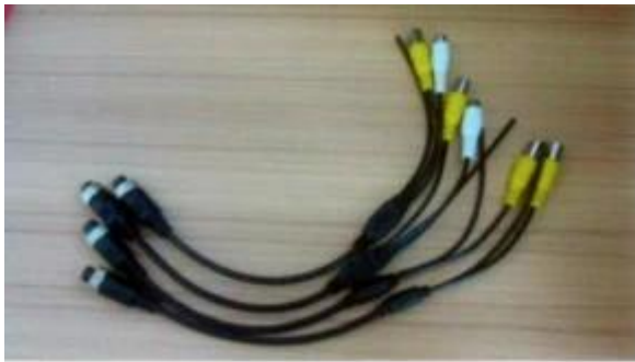
AV Input Cables
